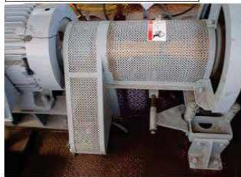
巻きまれ防止のカバーを付けた継手部
