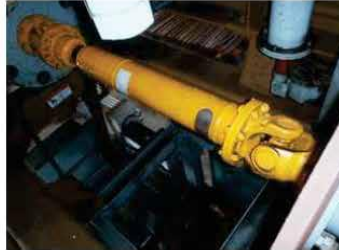
巻きまれ防止のカバーを付けた継手部
