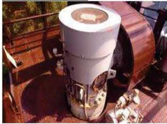
減速機の振動検査
