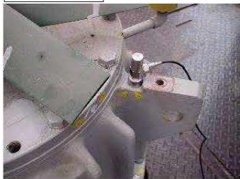
減速機の振動検査
