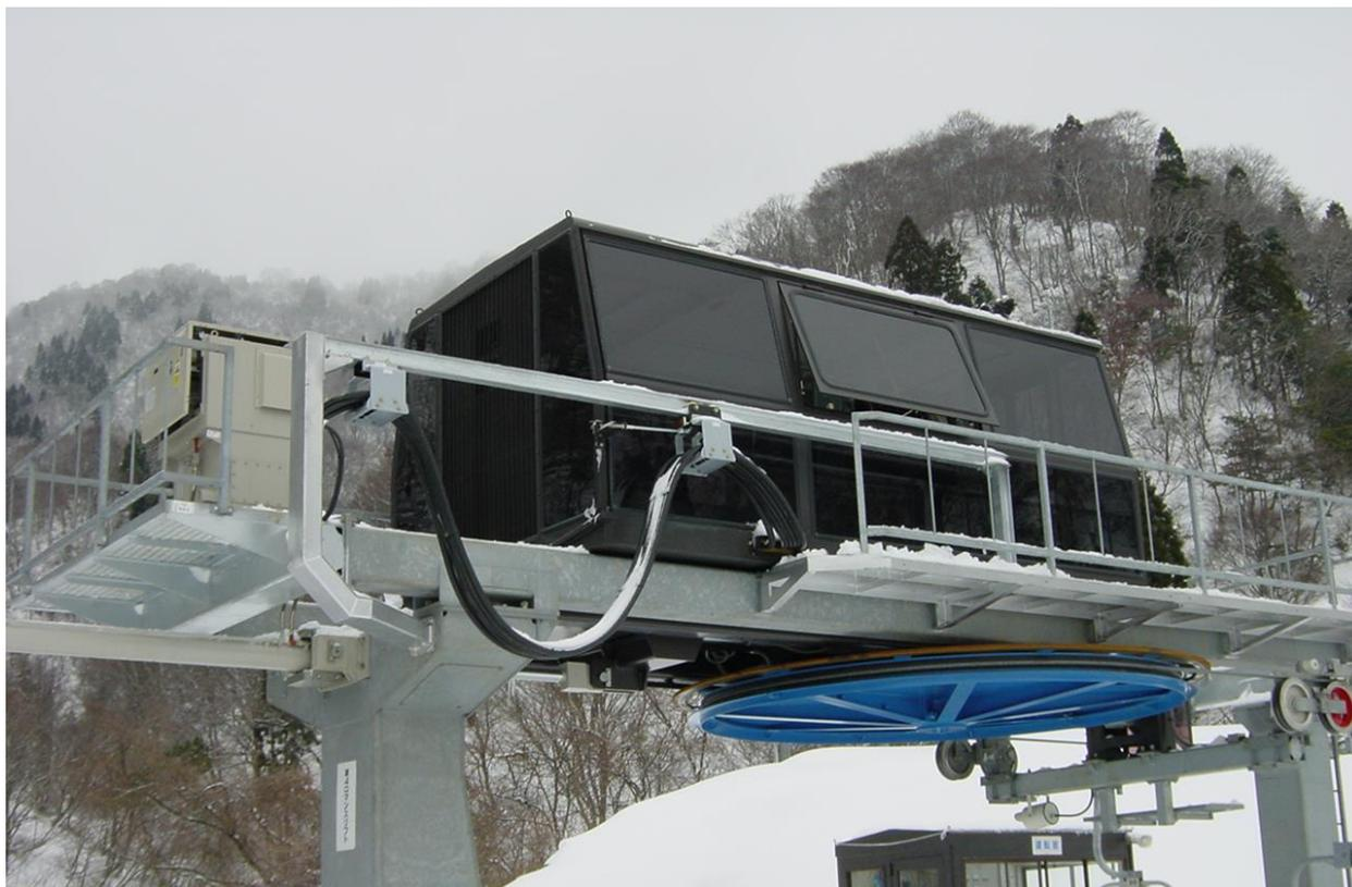
滑車直結式（原動緊張設備）
