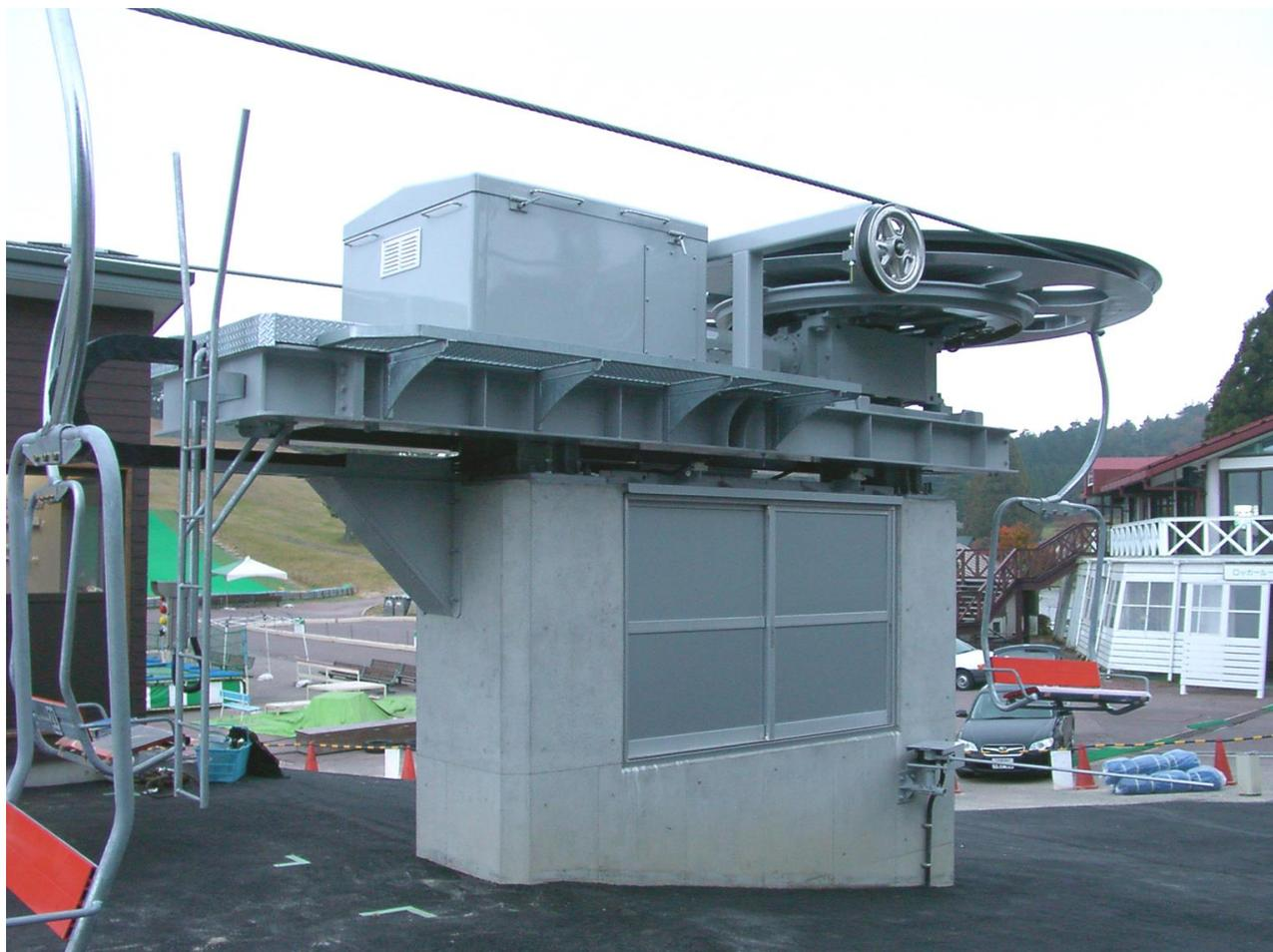
滑車直結式（原動緊張設備）
