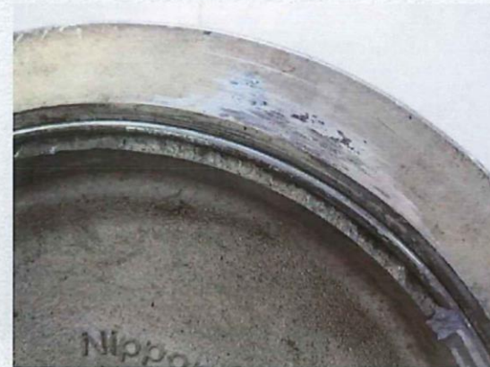
摩耗欠損したフランジ
