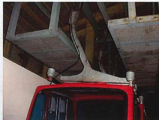
吊り部が折損した搬器
