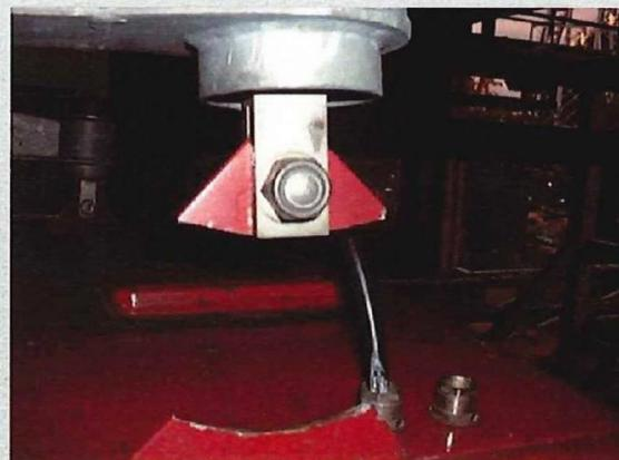
折損した吊り部拡大
